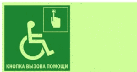
Рисунок 7 - Пример комбинированного знака вызова помощи для инвалидов-колясочников
