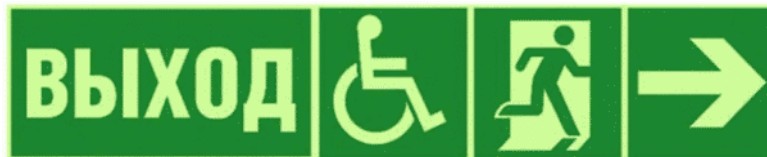
Рисунок 5 - Пример комбинации эвакуационных знаков
