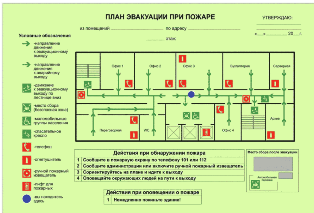
Рисунок 9 - Пример плана эвакуации
